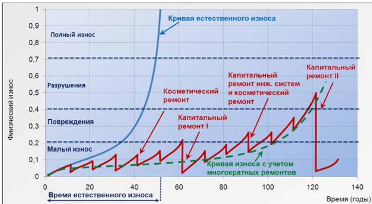
Рисунок 6. Процесс физического ветшания с учётом ППР
